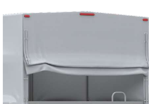
Контурные огни и дополнительный сигнал торможения (для широкой платформы)
