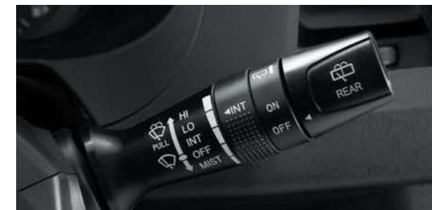
Правый подрулевой переключатель с регулировкой паузы стеклоочистителя
