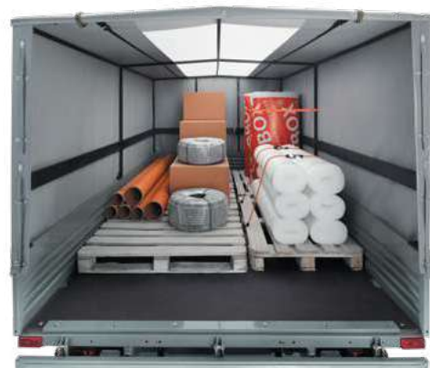
Световое окно тента позволяет видеть груз без дополнительной подсветки
