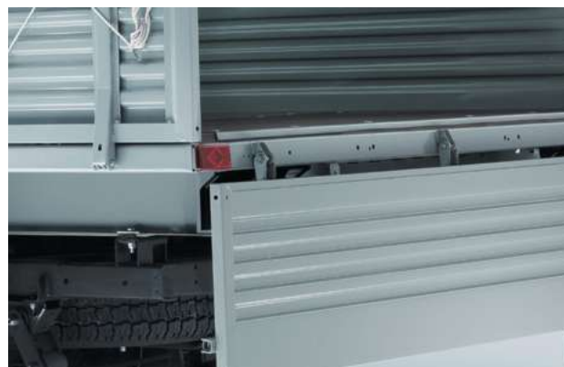
Катафоты, обозначающие габариты автомобиля с открытым задним бортом
