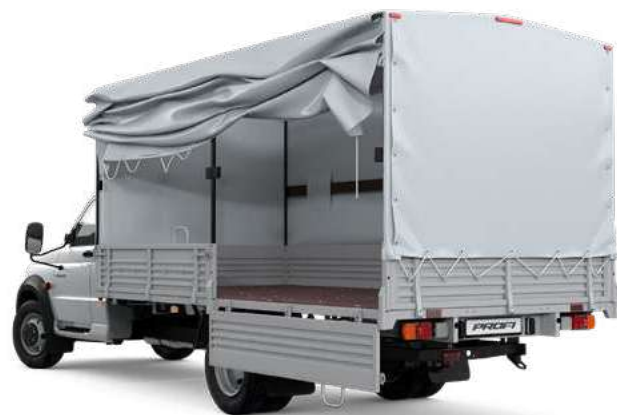
Платформа с возможностью отдельного открывания бортов
