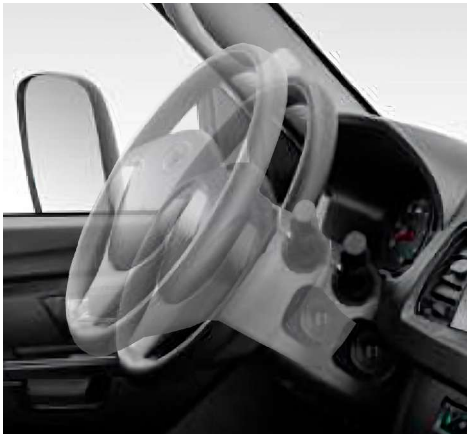
Регулировка руля по высоте и по вылету
