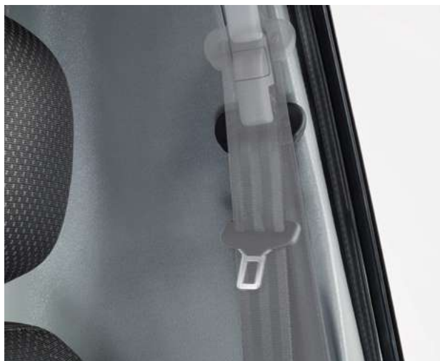
Ремни безопасности с регулировкой по высоте
